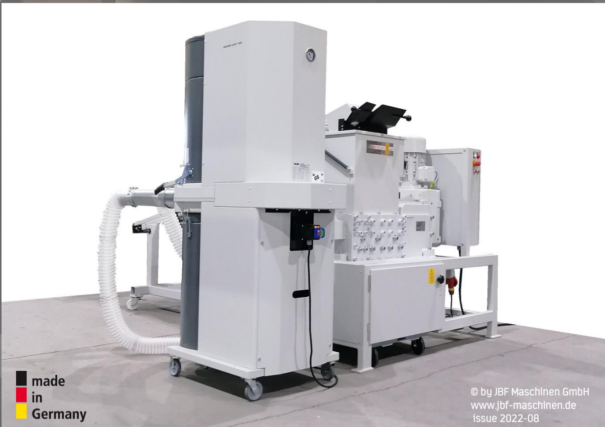
Absauganlage zur Erfassung und Sammlung des beim Schreddern erzeugten Staubes. Vacuuming system for removal and collection of dust, generated during shredding.
